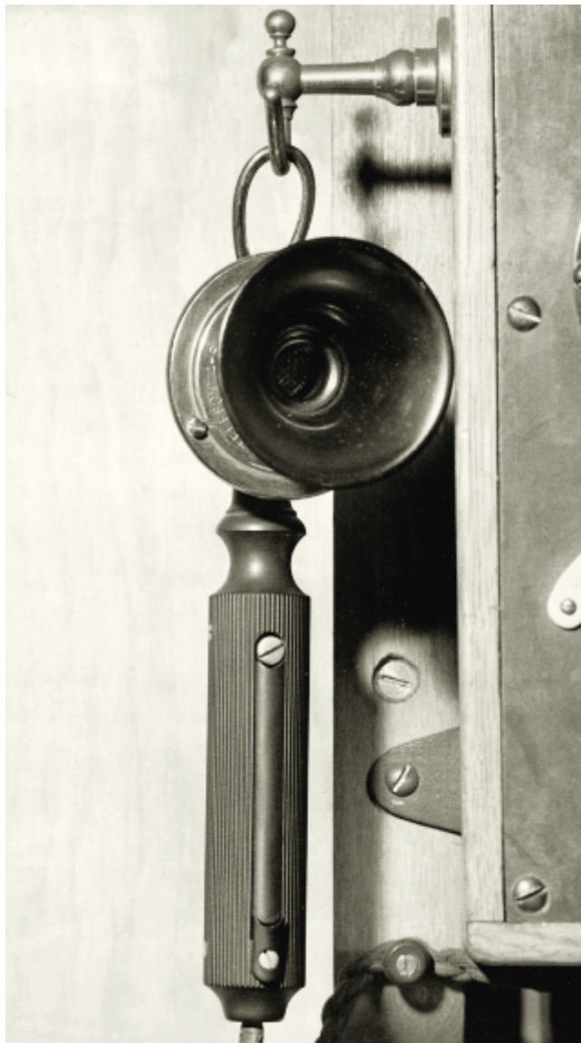
Membranmikrofon kallad "taltratt" som användes under provsändningsperioden 1923–1924.
