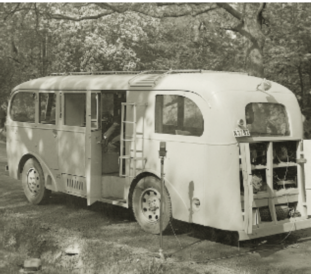
När behovet av ytterligare programmaterial från landsorten ökade införskaffade Radiotjänst större fordon med bättre inspelningsmöjligheter. Ljudbussen på bilden är från 1937. Den kostade ca 20 000 kronor och innehöll bl.a. 4 000 meter sladdar, som gjorde att mikrofonen, "sockerbiten", kunde placeras ganska långt från fordonet vid reportage i terräng. I bussen fanns också ett grammfonbord för inspelning av lackskivor. FOTO: SVT BILD
