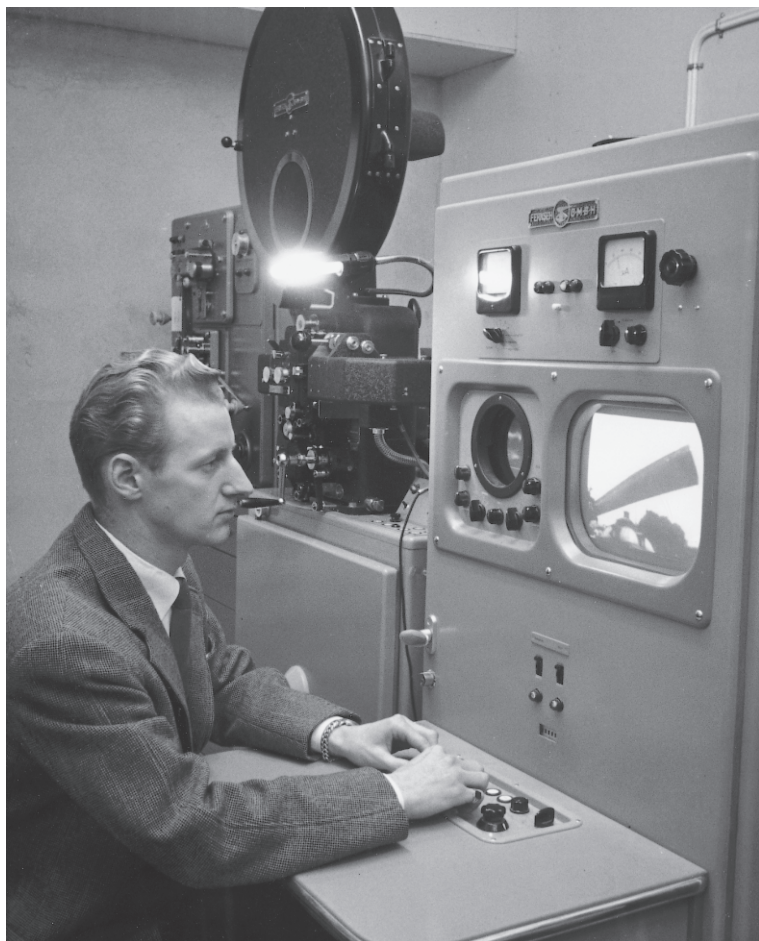
Åke Lundin vid den Fernseh-scanner som användes vid TV-starten 1956. (Foto: SVT Bild)
