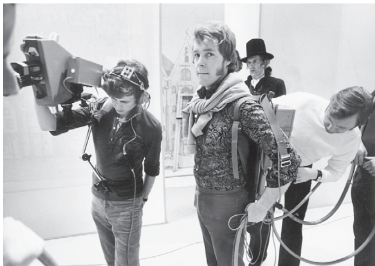
Den tidiga ENG-tekniken var otymplig. Tung kamera på axeln plus en ännu tyngre bandspelarryggsäck på medföljande kabelansluten bärare. (Foto: SVT Bild)
