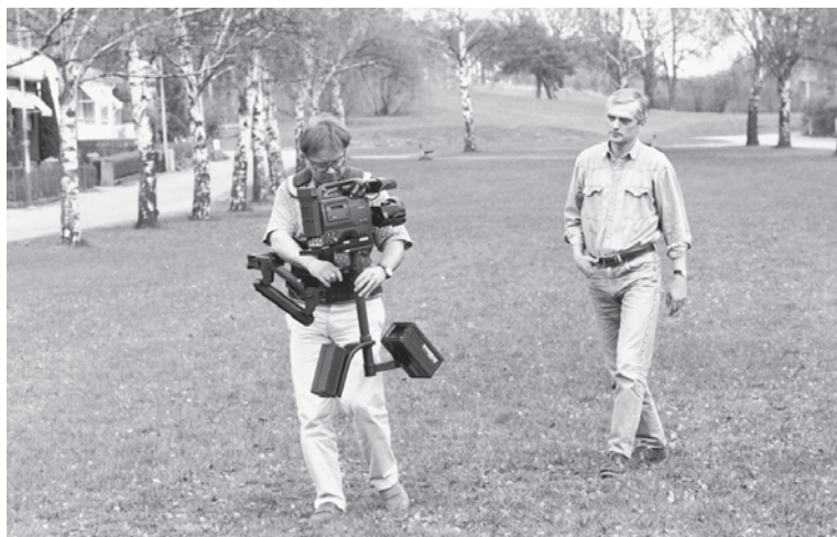
Videokamera monterad på Steadicam. Som synes går det alldeles utmärkt att filma bakåt under förflyttning. (Foto: Jarl Hofmann AB)
