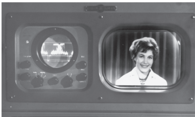
T.v. ett oscilloskop (vågformmonitor) och t.h. den TV-bild som oscilloskopet omvandlar till ingenjörstekniskt mätbara data. (Foto: SVT Bild)
